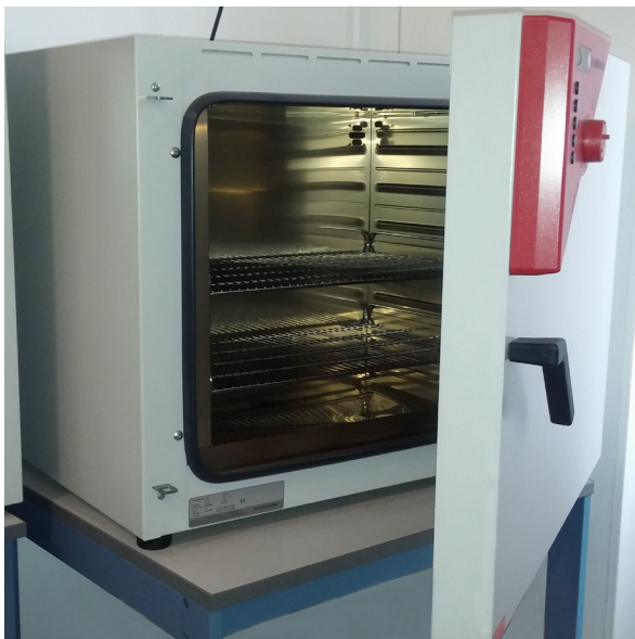
Figura 76.4 Forno Pasteur. Dispositivo per la sterilizzazione a calore secco.
