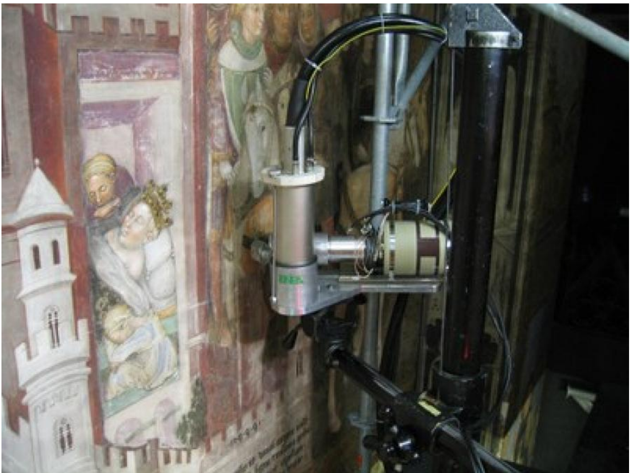
Analisi con strumentazione XRF portatile sugli affreschi della Cappella Teodolinda nel Duomo di Monza.
