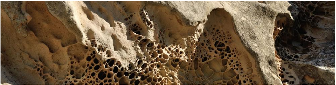
Erosione alveolare di un'arenaria naturale.
