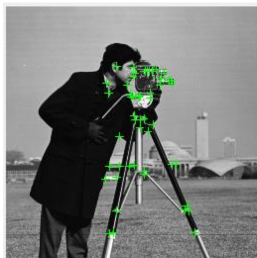
Figura 8 – Esempio dei punti estratti dalla funzione detectMinEigenFeatures
