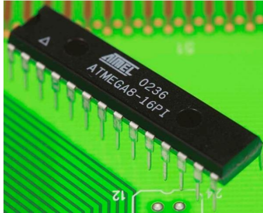
Un microcontrollore Atmel ATMEGA8–16PI come quello usato sui primi prototipi di Arduino
