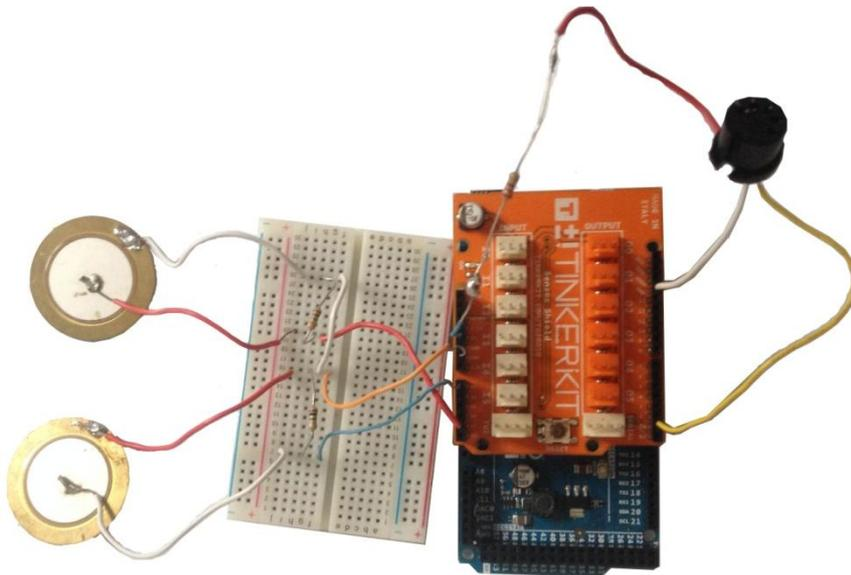
Come si può vedere il connettore 4 va ai 5V positivi e il connettore 3 va al ground. Il connettore 2 va al serial 1 (TX1).
