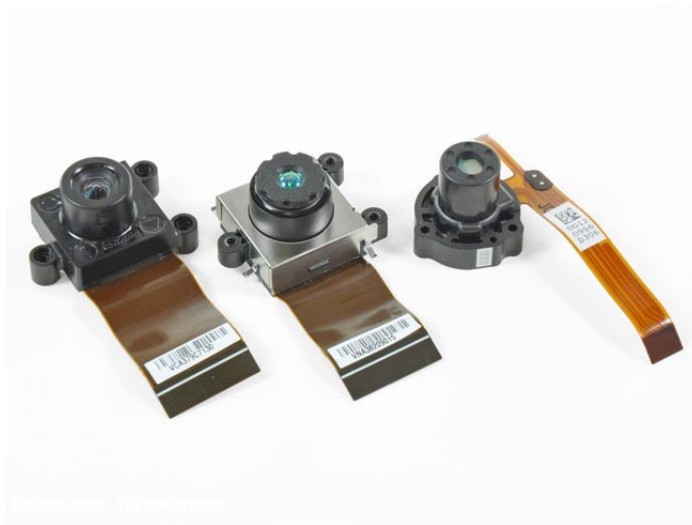
Figura 1.5: I tre sensori video: proiettore, ricevitore e telecamera.
