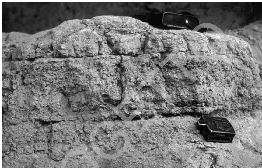
Fig. 14 – Unità PTI presso il Sepolcro degli Scipioni, in cui si possono osservare i livelli a lapilli accrezionari.
