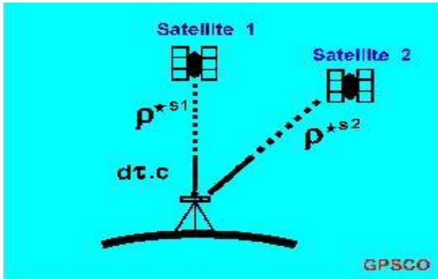
$$\rho_1(t_1) = r_1(t_1) + c \cdot t_u$$
