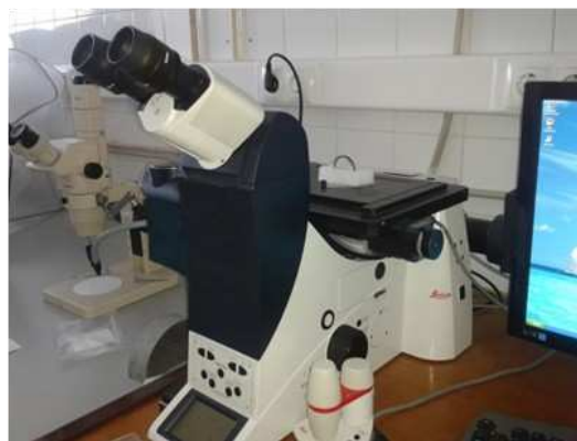
Fig. 2. Observação de uma argola por Microscopia Ótica no microscópio Leica DMI5000M instalado no CENIMAT/I3N da FCT-UNL.
