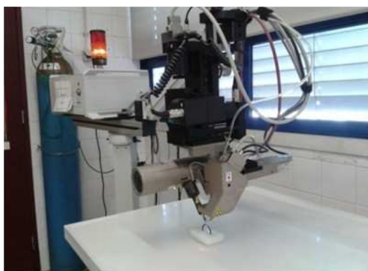
Fig. 1. Análise de uma argola por micro-EDXRF no espectrómetro ArtTAX Pro instalado no Departamento de Conservação e Restauro da FCT-UNL.
