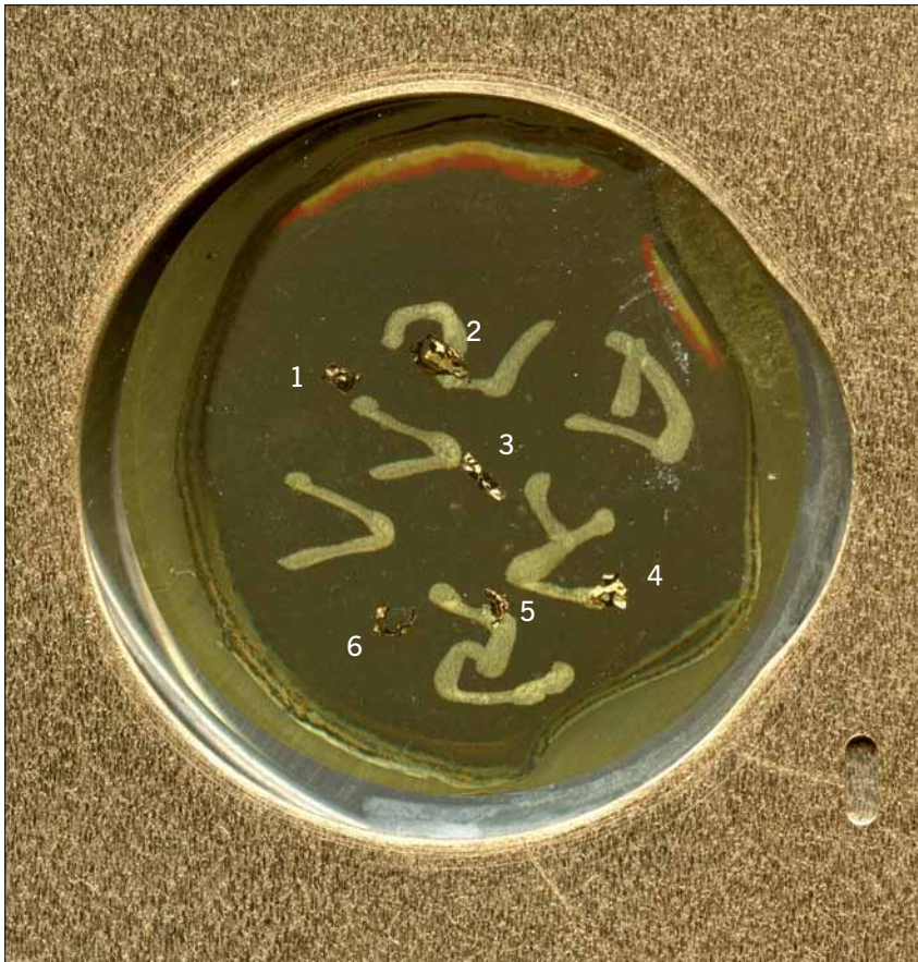
Abb. 1 Anordnung der in Kunstharz eingebetteten Goldproben von KV 55. Die Probennummern sind in Weiß neben den Goldflittern zu erkennen.
