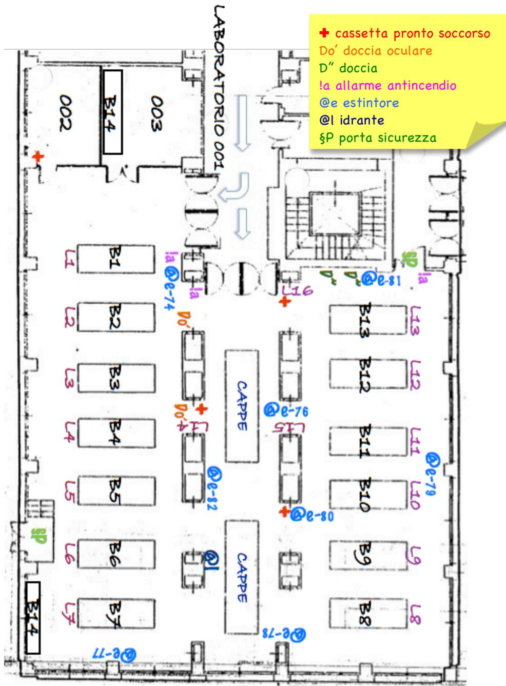
Collocazione dei dispositivi di sicurezza nel laboratorio didattico di chimica generale e inorganica (Preparazioni Chimiche I) del Dipartimento di Chimica – 001 p. terra edificio V. Caglioti (CU032).
