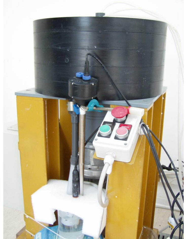
Utilizzo di un nefelometro per monitoraggio della concentrazione della sospensione
