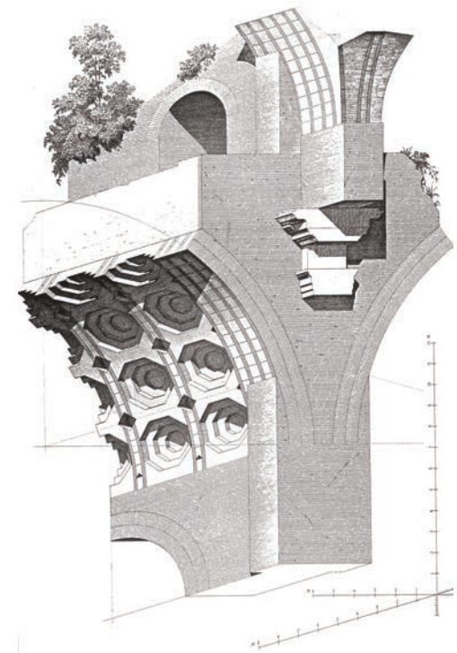
144. Per descrivere l'attacco delle volte a crociera della navata della Basilica di Costantino, Choisy si serve di una assonometria cavaliera, che conserva la vera forma del fronte.
