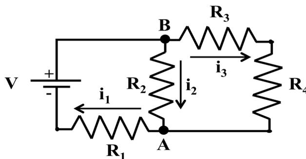
(a) Le due resistenze in serie  $R_3$  e  $R_4$  equivalgono a  $R_{34} = R_3 + R_4$ ;  $R_{34}$  e la resistenza  $R_2$  sono soggette alla stessa ddp.
