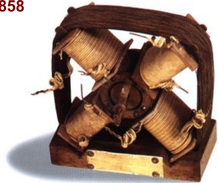
Macchina asincrona - Galileo Ferraris, 1885
