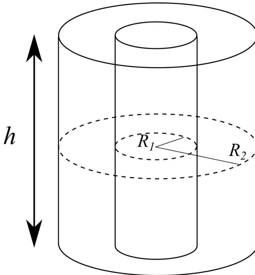
Un conduttore cilindrico cavo di lunghezza  $h$  ha raggio interno  $R_1$  ed esterno  $R_2$  ed è costituito da un materiale di resistività  $\rho$ .
