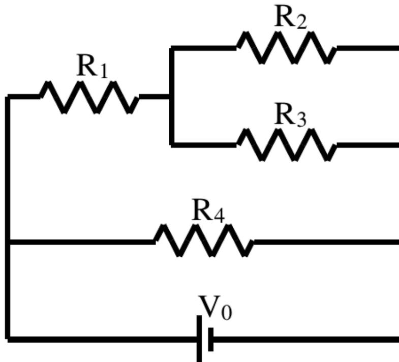
1. Calcolare la resistenza equivalente.
