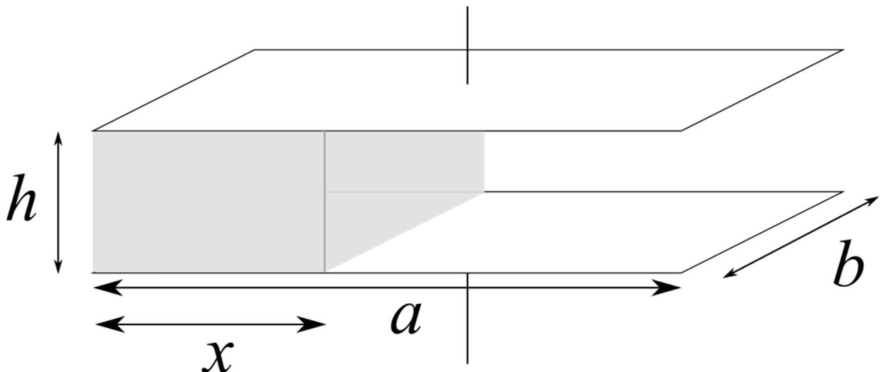
Un condensatore piano di dimensioni  $a \times b \times h$  è parzialmente riempito (per un tratto  $x = a/3$ ) di una lastra di dielettrico omogeneo e isotropo di costante dielettrica relativa  $\kappa$  e mantenuto ad una d.d.p.  $\Delta V$ .
