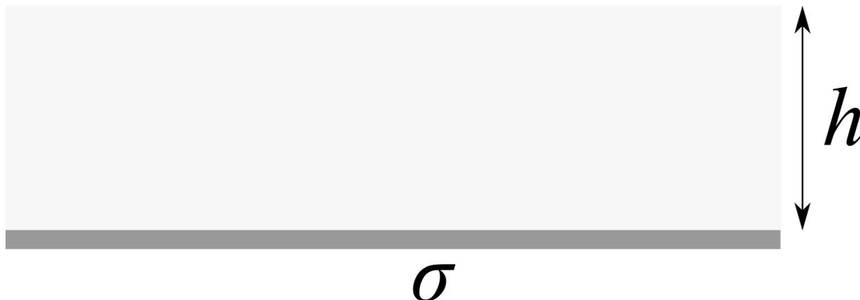
Un piano conduttore indefinito è carico con densità superficiale di carica  $\sigma$ . Su una delle due superfici viene appoggiata una lastra di materiale dielettrico omogeneo e lineare di spessore  $h$  e costante dielettrica  $\kappa$ .
