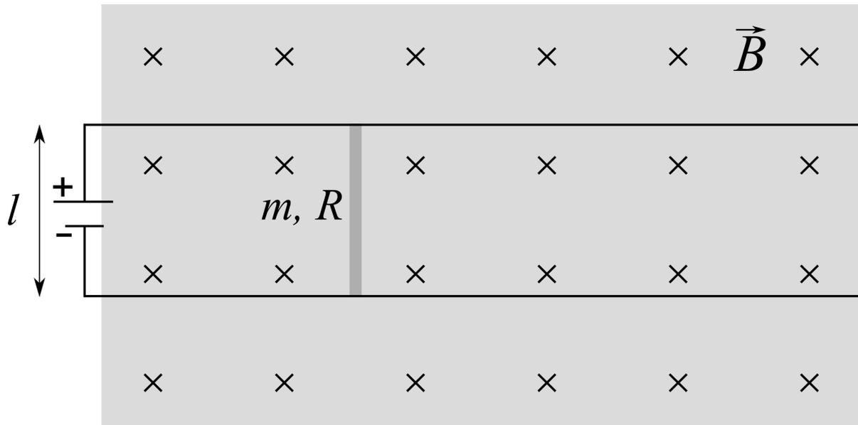
Una barra conduttrice, di massa  $m = 100 \text{ g}$  e resistenza  $R = 500 \Omega$ , appoggia senza attrito su due binari orizzontali di resistenza trascurabile. La distanza tra i binari è  $l = 40 \text{ cm}$  e il sistema è immerso in un campo magnetico uniforme  $B = 0.8 \text{ T}$ , perpendicolare ai binari ed alla barra (entrante nel foglio, vedi figura). All'istante  $t = 0$  la barra è ferma e tra i binari viene posto un generatore con la polarità indicata in figura.
