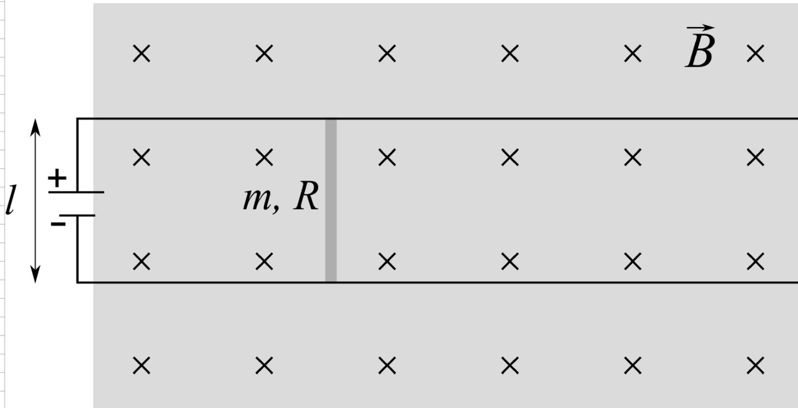
Una barra conduttrice, di massa  $m = 100 \text{ g}$  e resistenza  $R = 500 \Omega$ , appoggia senza attrito su due binari orizzontali di resistenza trascurabile. La distanza tra i binari è  $l = 40 \text{ cm}$  e il sistema è immerso in un campo magnetico uniforme  $B = 0.8 \text{ T}$ , perpendicolare ai binari ed alla barra (entrante nel foglio, vedi figura). All'istante  $t = 0$  la barra è ferma e tra i binari viene posto un generatore con la polarità indicata in figura.
