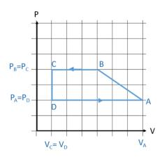
Si può trovare la pressione in A usando l'equazione di stato dei gas perfetti
