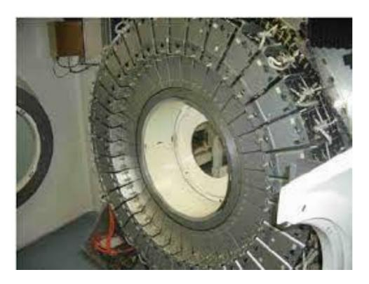
I blocchi sono a loro volta organizzati in **anelli** posti nel gantry attorno al paziente. I tomografi di ultima generazione hanno più anelli contigui che permettono l'acquisizione di estesi campi di vista assiali.
