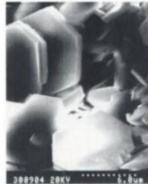
Fig. 6. Caolinite: microfotografia al microscopio elettronico a scansione. Vedi disegno della strumentazione del SEM EDS in 19.1
