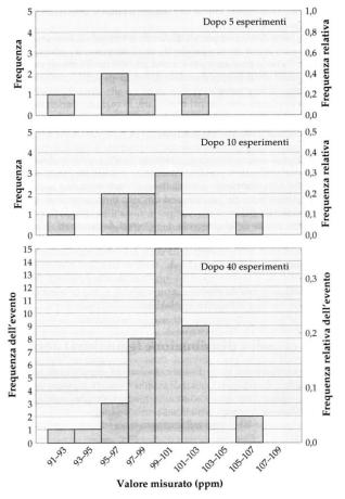
Per un numero elevato di prove è possibile correlare la deviazione standard s di numero finito di prove, con σ riferito ad numero infinito di prove
