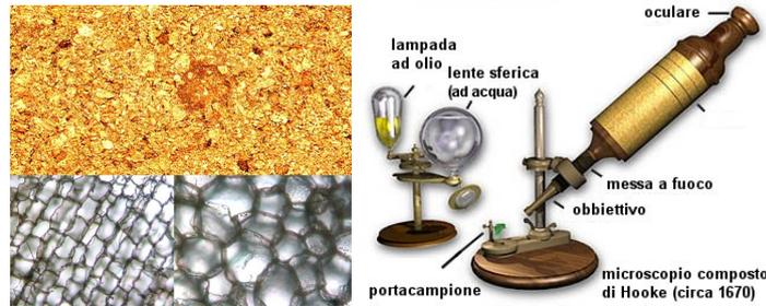
Figura 17: Cellule di sughero - Microscopio di Hooke
