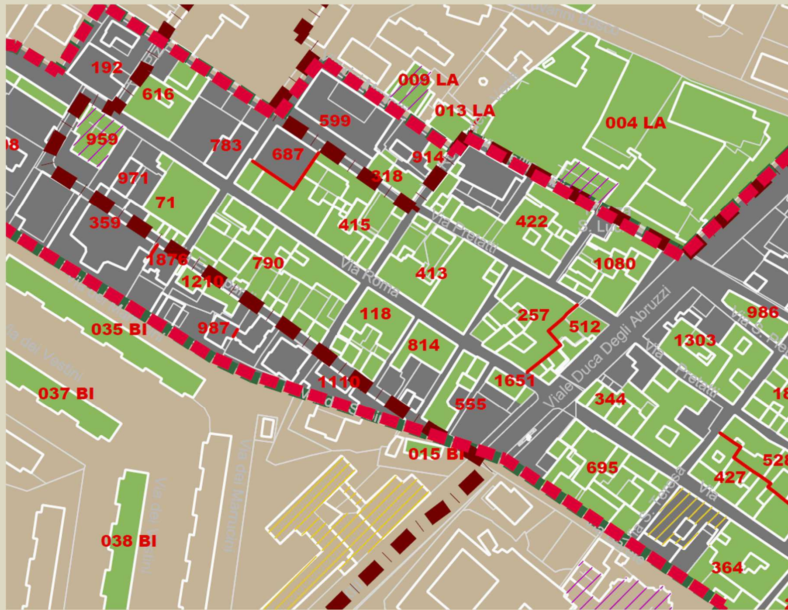
Stralcio del Piano di ricostruzione dell'aquila con l'identificazione degli aggregati strutturali individuati
