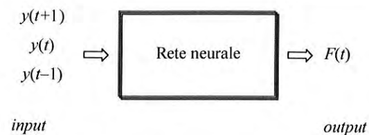
Figura 13.21 Schema degli input e degli output che la rete deve imparare a correlare.
