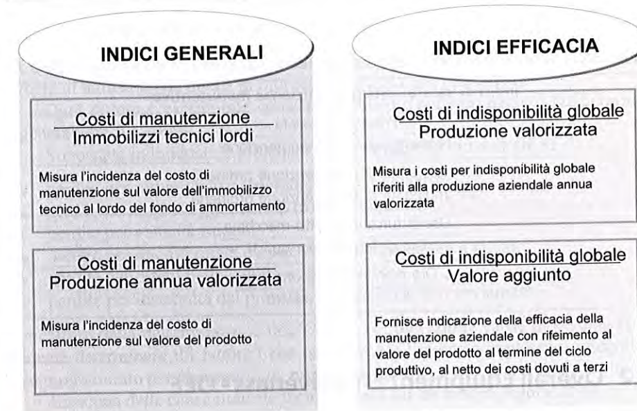
Figura 20.2 Esempi di indici generali e di efficacia del sistema manutentivo (Fonte: UNI 10388).
