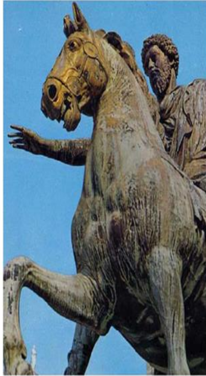
Fig. 1.20 – Bronzo di Marco Aurelio in Campidoglio (ora l'originale è custodito in museo ). I bronzi dorati sono soggetti a corrosione soprattutto in ambiente inquinato da \text{SO}_2
