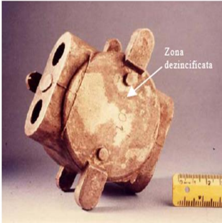
Fig. 1.12 - Attacco selettivo (dezincificazione di un ottone)
