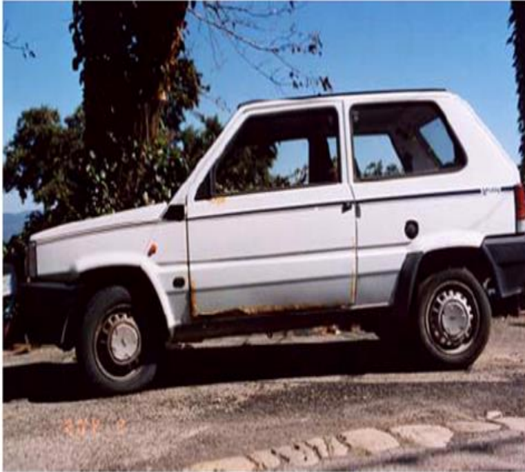
Fig. 1.8 - Corrosione detta “in-out” che parte dall’interno della carrozzeria dell’auto
