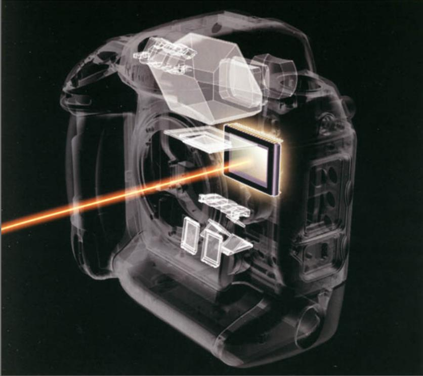
**Il CCD (microprocessore elettronico di silicio composto da molti circuiti) si trova sul piano focale dell'obiettivo. Traduce la luce in variazione di corrente, trasformando quest'ultima in dati binari, ovvero in bit, infine convertiti in dati .tiff o .jpg. È costituito da una griglia di pixel (matrice rettangolare), ciascuno costituito da tre recettori sensibili ai tre colori rosso, verde, blu.**
