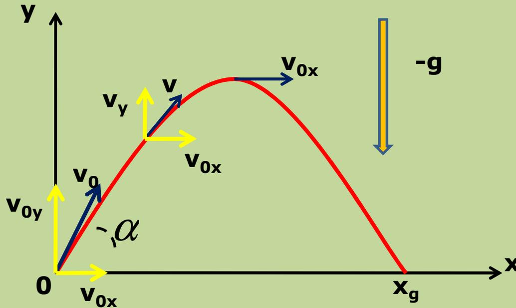
La componente della velocità lungo l'asse  $y$  varierà, annullandosi nel punto di massima quota.
