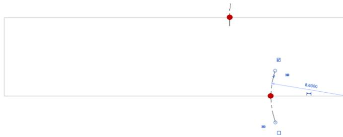
Inseriamo una linea di modello che passi per i due punti individuati ed estendiamo trascinandone le estremità indefinitamente. In seguito, sempre grazie ad archi di cerchio, stacchiamo le estremità di quel primo spigolo sulla linea disegnata in precedenza. Ridefiniamo le estremità della linea limitandola agli archi di cerchio trascinandone le estremità. Completiamo il disegno del rettangolo con altre *linee di modello*, secondo le misure prese dal disegno di rilievo.
