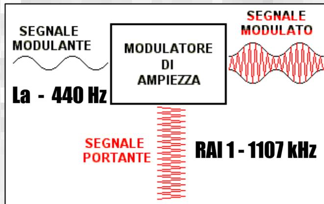
Uno dei sistemi impiegati per la trasmissione delle informazioni utilizzando un segnale a radiofrequenza è la modulazione di ampiezza **AM** (i.e., *amplitude modulation*) che consiste nel **modulare** l'ampiezza del segnale radio che si intende utilizzare per la trasmissione (detto **portante**) in maniera proporzionale all'ampiezza del segnale che si intende trasmettere (detto **modulante**) e che contiene l'**informazione**.
