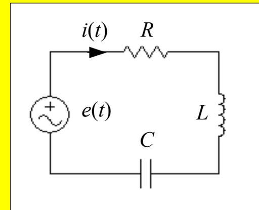
La soluzione dell'equazione integro-differenziale stata ricondotta alla soluzione di una equazione algebrica definita nel campo dei numeri complessi. Il fasore,  $\tilde{I}$ , soluzione dell'equazione algebrica, contiene la cercata soluzione,  $i(t)$ , definita nel dominio del tempo.
