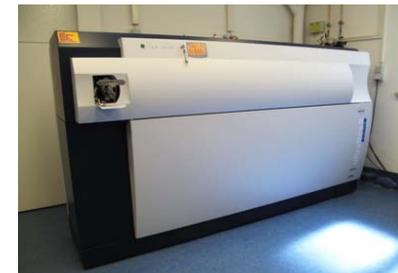
Dopo essere stati vaporizzati/ionizzati, gli ioni sono accelerati all'interno di un tubo cavo da un'energia cinetica costante emessa da un generatore (TOF)
