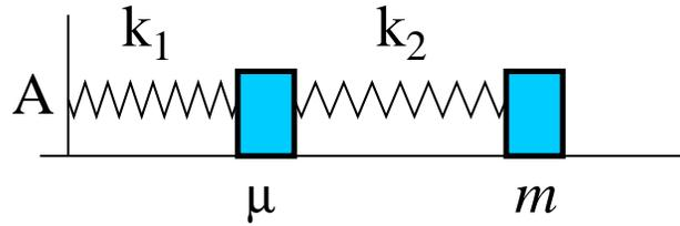
Un modello semplice che permette di capire il comportamento di un punto materiale connesso ad una molla di massa non trascurabile è disegnato in figura. La massa della molla è rappresentata da una massa  $\mu$  connessa a due molle di costanti elastiche uguali, con  $k_1 = k_2 = 2k$  e lunghezza a riposo  $l_0/2$ . Le dimensioni delle due masse sono trascurabili (punti materiali).
