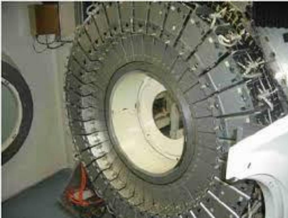
I blocchi sono a loro volta organizzati in **anelli** posti nel gantry attorno al paziente. I tomografi di ultima generazione hanno più anelli contigui che permettono l'acquisizione di estesi campi di vista assiali.
