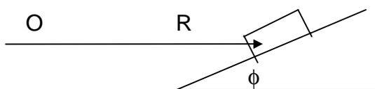
3) Dopo quale distanza si ferma un proiettile di massa  $m=3$  g, che colpisce un muro di legno posto su piano orizzontale (vedi figura) se la forza frenante è costante di valore  $10$  N e la velocità iniziale del proiettile rispetto al piano è  $v=30$  m/s ? Si trascurino scambi di energia termica e si assuma il muro immobile.
