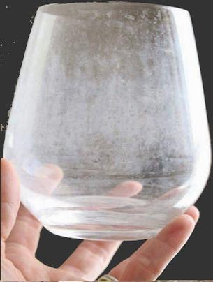
Quando l'acqua sotterranea incontra l'aria, la  $\text{CO}_2$  esce dalla soluzione e causa la precipitazione di  $\text{CaCO}_3$
