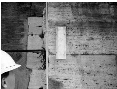
FIGURA 5.25 Roma, Colosseo. Trasduttore a filo per rilevare gli spostamenti verticali
