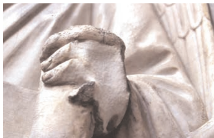
b) Degrado fisico-meccanico dovuto a fenomeni di dilatazione termica: particolare di una statua in marmo apuano sulla facciata del Duomo di Firenze; la rottura è dovuta alle dilatazioni termiche differenziali nel materiale anisotropo "marmo cotto" (foto di F. Fratini).
