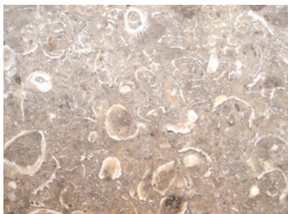
a) Calcare organogeno a Merida (Messico). La presenza di conchiglie nel materiale lapideo è visibile, in questo caso, ad occhio nudo.
