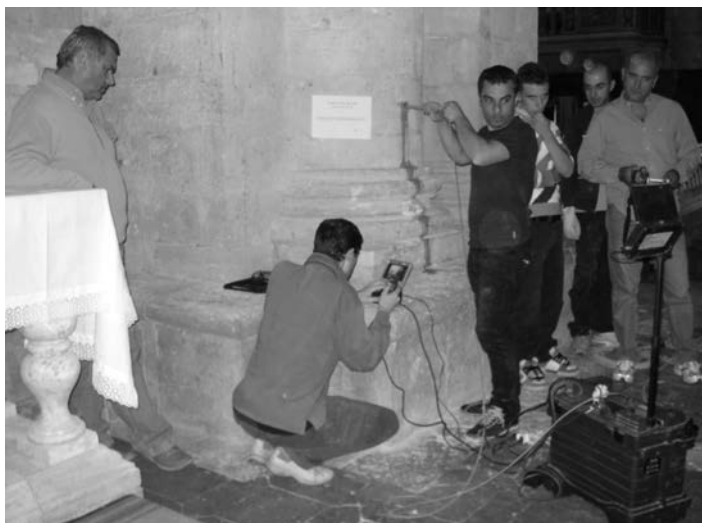
FIGURA 5.15 Montepulciano (Siena), chiesa di S. Biagio. Esecuzione di un'indagine videoendoscopica (test n. 9, quota 3,47 m)
