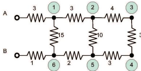
(i valori delle resistenze sono date in *Ohm*) quando tra  $A$  e  $B$  è applicata una differenza di potenziale di  $100 \text{ Volt}$ .
