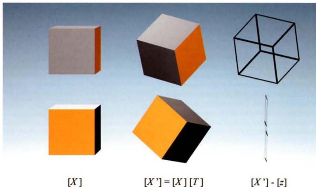
1/ *Pagina precedente.* La rappresentazione digitale non fa uso dell'operazione di proiezione e sezione che è a fondamento della geometria descrittiva classica, ma opera una sorta di "schiacciamento" delle figure, annullando l'ordinata  $z$  che ne descrive la profondità.
