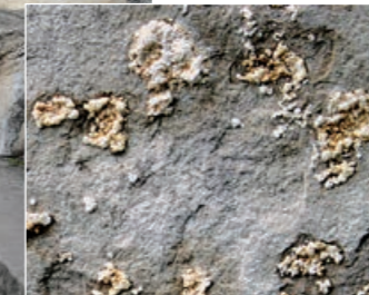
Limestone block showing salt efflorescences . Bloque de caliza mostrando eflorescencias salinas.
