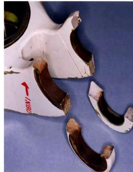
Corrosione sotto sforzo di un componente di carrello di atterraggio di aeromobile
