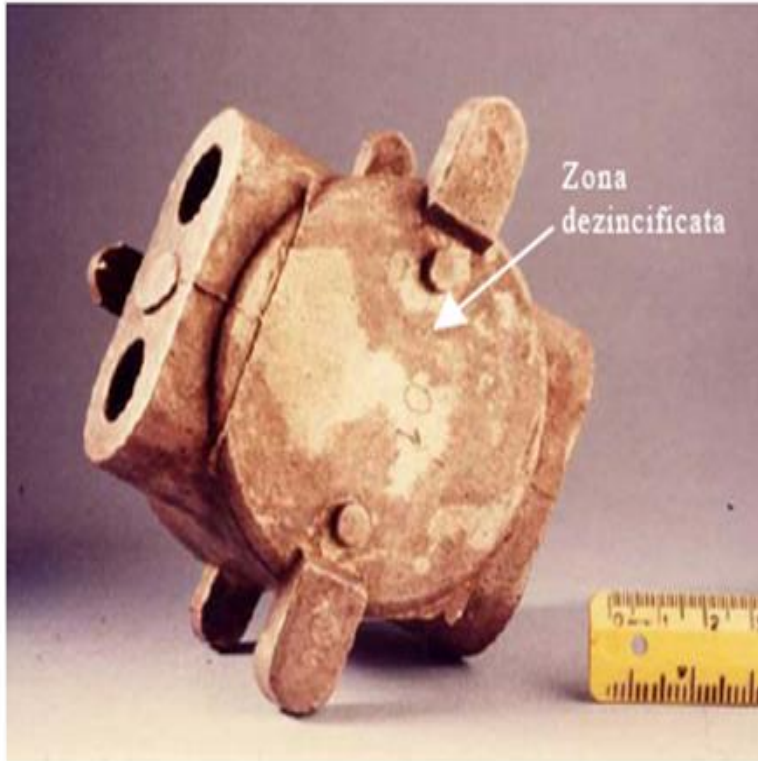
Fig. 1.12 - Attacco selettivo (dezincificazione di un ottone)
