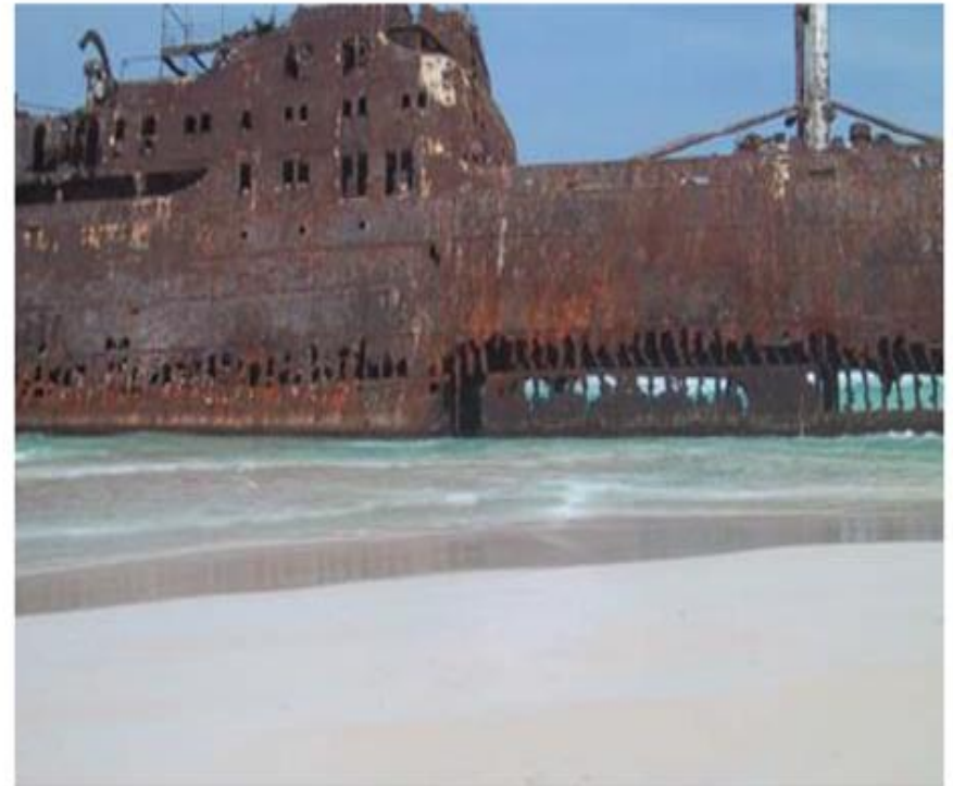
Fig. 1.5 - Corrosione generalizzata di un relitto (Isola di Capo Verde)
