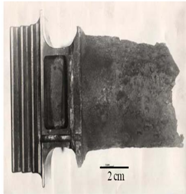
Fig. 1.19 - Corrosione (a caldo) di una paletta di una turbina gas
