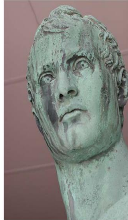
Fig. 1.21 - Statua in bronzo di Napoleone della fine dell'ottocento. Le macchie nere, dovute a prodotti carboniosi, non sono protettive (Milano, 2003)
