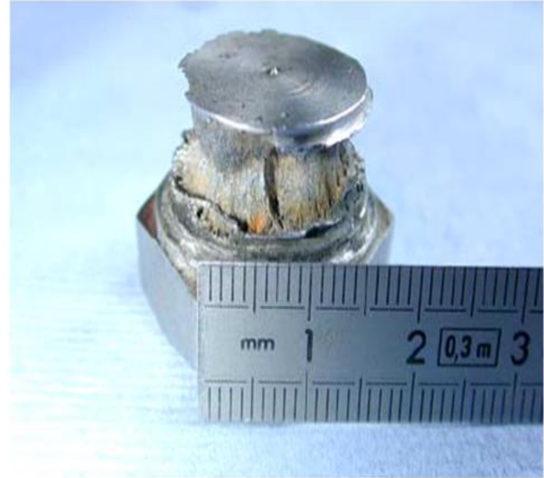
Fig. 1.9 - Corrosione in fessura di un bullone in acciaio inossidabile (AISI 304)
