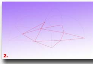
2. Chiudere ora i "petali" facendo coincidere i vertici dei triangoli in un solo punto facendo cerniera sul lato di base
