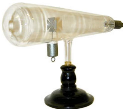
Figura 2.1: Un tubo catodico utilizzato da Crookes: la croce maltese di metallo all'interno serviva per dimostrare l'assorbimento dei raggi catodici, con formazione di un'ombra sullo schermo fluorescente (a sinistra).
