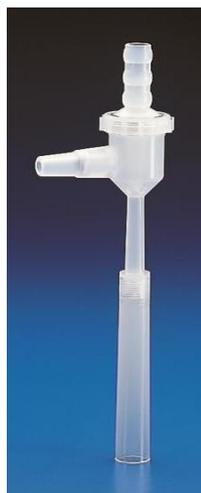
La pompa a getto d'acqua, inventata da R.W. Bunsen, è basata sull'effetto Venturi, cioè sulla riduzione di pressione di un liquido quando percorre un tubo con una strozzatura.
