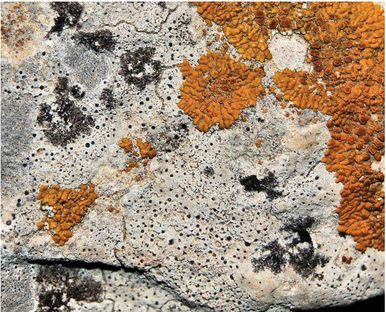
Pitting su calcare prodotto dalle ife di licheni. Si notino anche le impronte ( probabili patine ad ossalati ) dei talli di licheni ormai staccati dal substrato.
