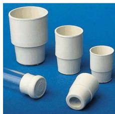
Fissate il tappo di gomma auto-sigillante ribaltabile (tappo da siero) al tubo di gomma terminale della pompa da vuoto ad acqua. Aprite il getto d'acqua della pompa al massimo e non
