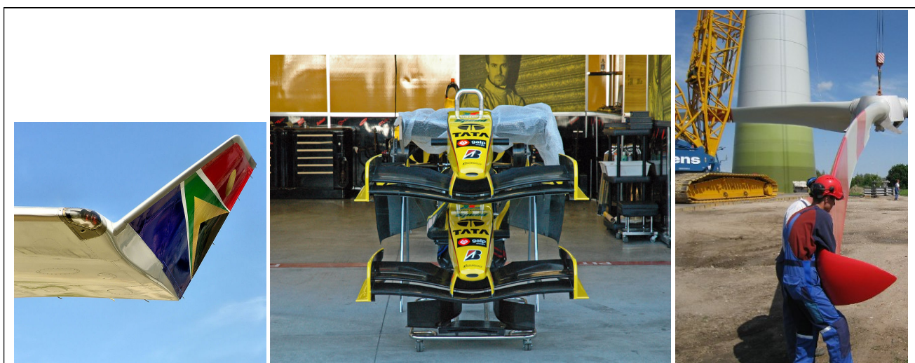
Figura 40. Esempi di "winglets" su aerei, autovetture e generatori eolici (Enerkon E82). Tratti da Wikipedia.
