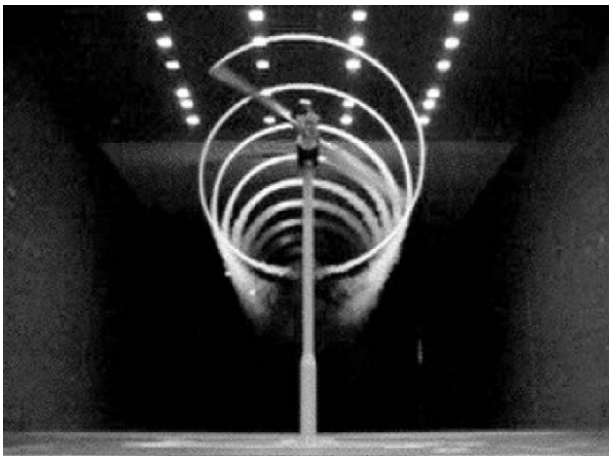
Figura 57. Vortici di estremità e radice su pale eoliche.
