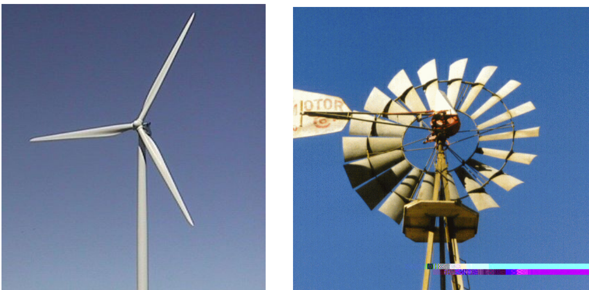
Figura 67. Rotore eolico per produzione di energia elettrica (a sinistra) e per estrazione d'acqua (a destra).
