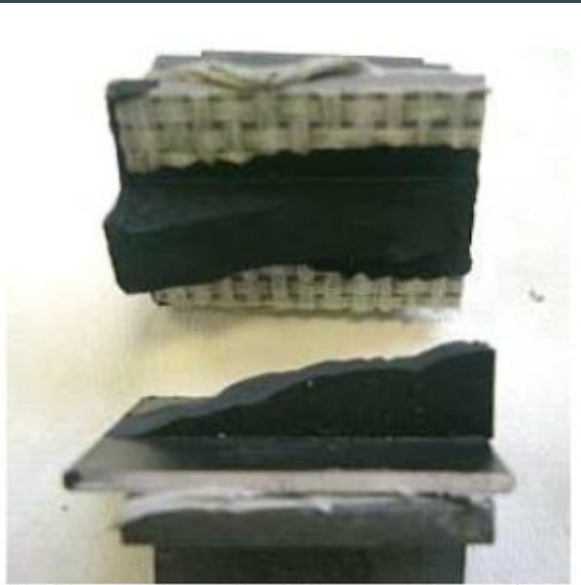
fig. 3 – configurazione 2 (con rete): campione sperimentale dopo trazione
